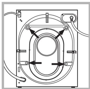
3. Снимите 4 транспортировочных болта, предохраняющие машину в процессе перевозки, и резиновую заглушку с соответствующей распорной шайбой, расположенные в задней части стиральной машины (см. схему).
